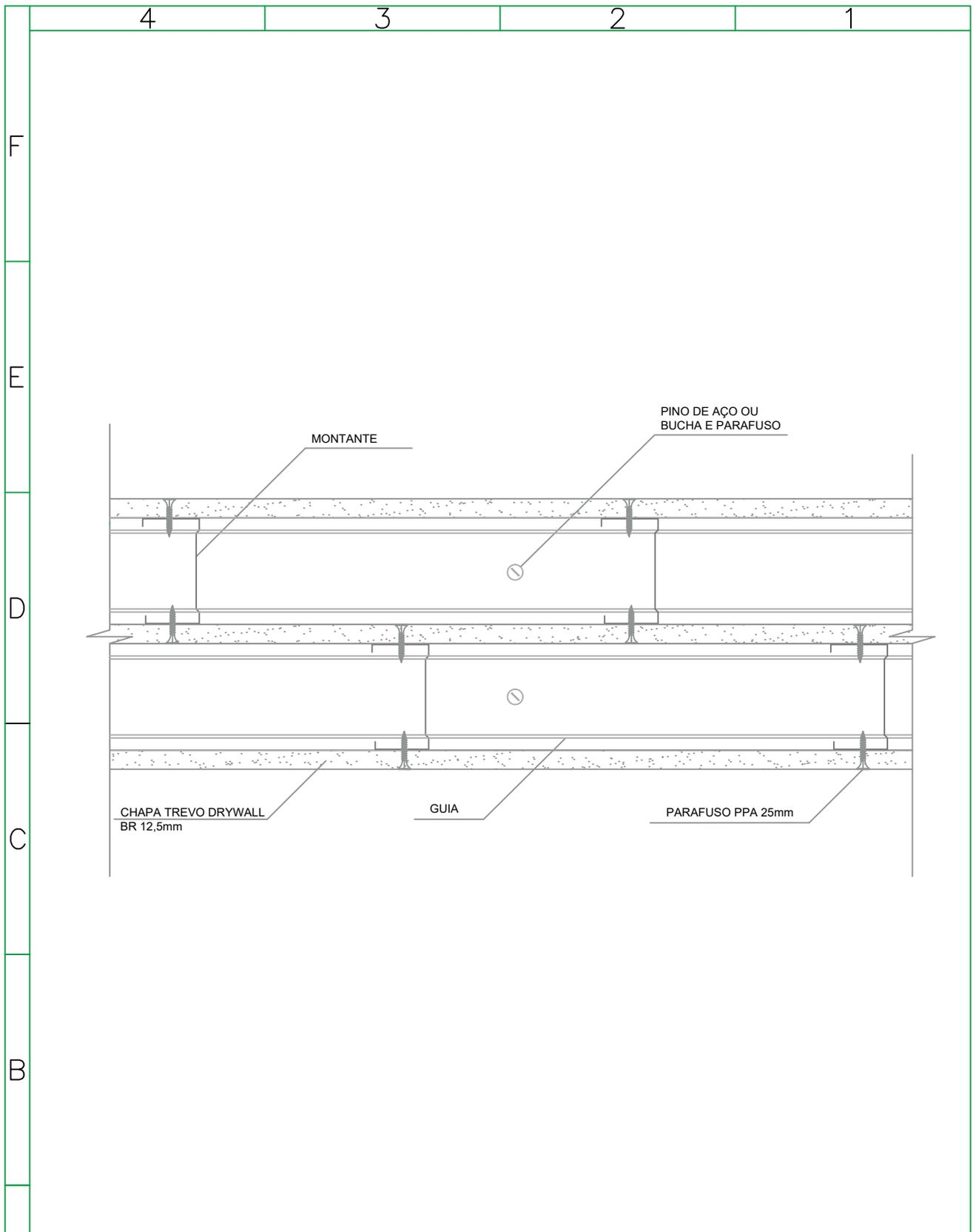
**DETALHE TÉCNICO:** PAREDE PARA LOJA DE SHOPPING - PLANTA BAIXA
