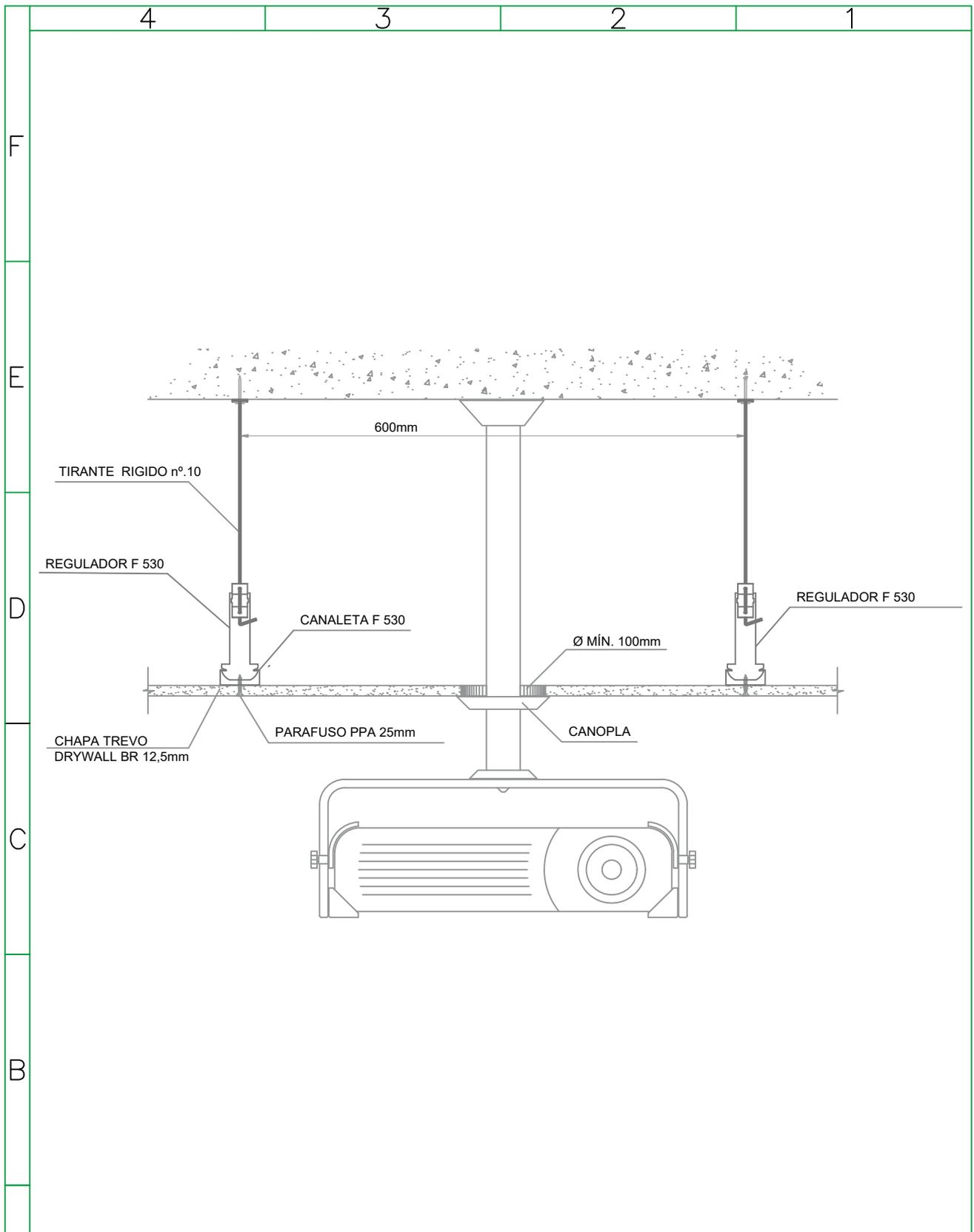
**DETALHE TÉCNICO:** CARGAS E REFORÇOS - FIXAÇÃO DO PROJETO NO TETO - CORTE
