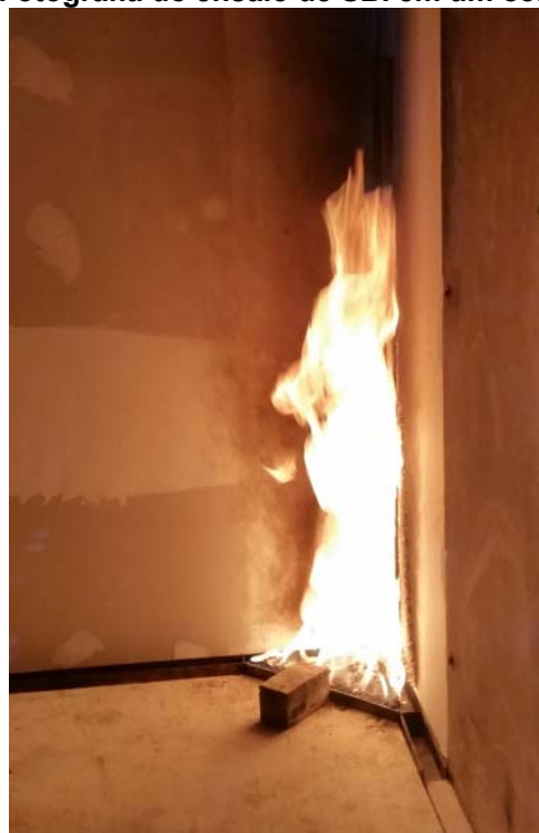
Figura 15– Fotografia do ensaio de SBI em um corpo de prova
