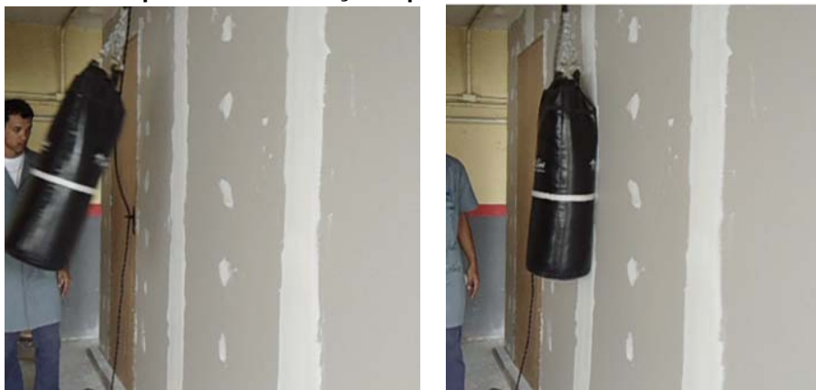
Figura 7 – Fotografias ilustrativas do ensaio de impacto de corpo mole - saco de areia em movimento pendular em direção à parede
