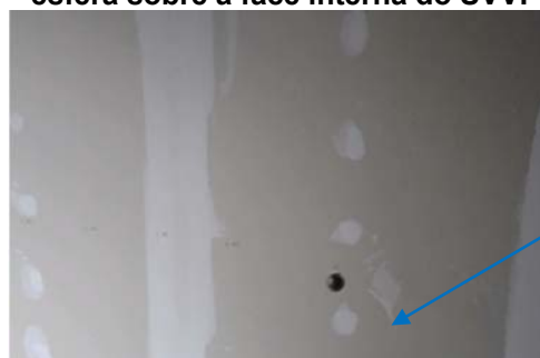
Figura 12 – Fotografia ilustrativa do ensaio de impacto de corpo duro - Movimento pendular da esfera sobre a face interna do SVVI
