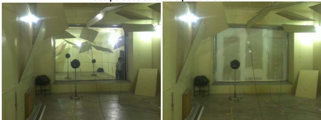
Figura 22 – Vista da câmara de ensaio do laboratório do IPT sem (esquerda) e com (direita) um dos pórticos de ensaio posicionados
