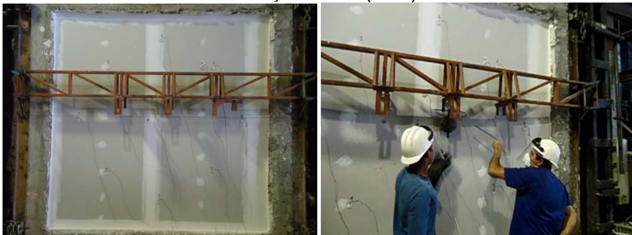
Figura 19– Detalhe do pórtico do ensaio montado (esquerda) e aplicação de impacto (20J) durante a execução do ensaio (direita)
