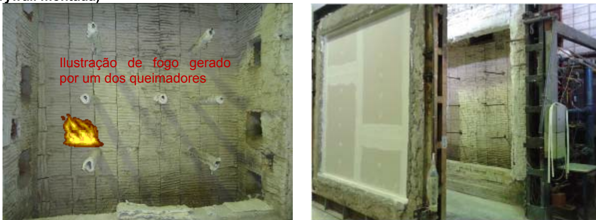
Figura 18 – Exemplo de parede em drywall fixada no forno do laboratório do IPT, com a colocação dos termopares na face oposta ao incêndio
