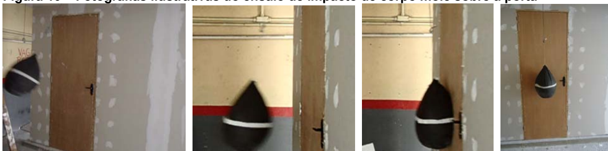
Figura 10 – Fotografias ilustrativas do ensaio de impacto de corpo mole sobre a porta
