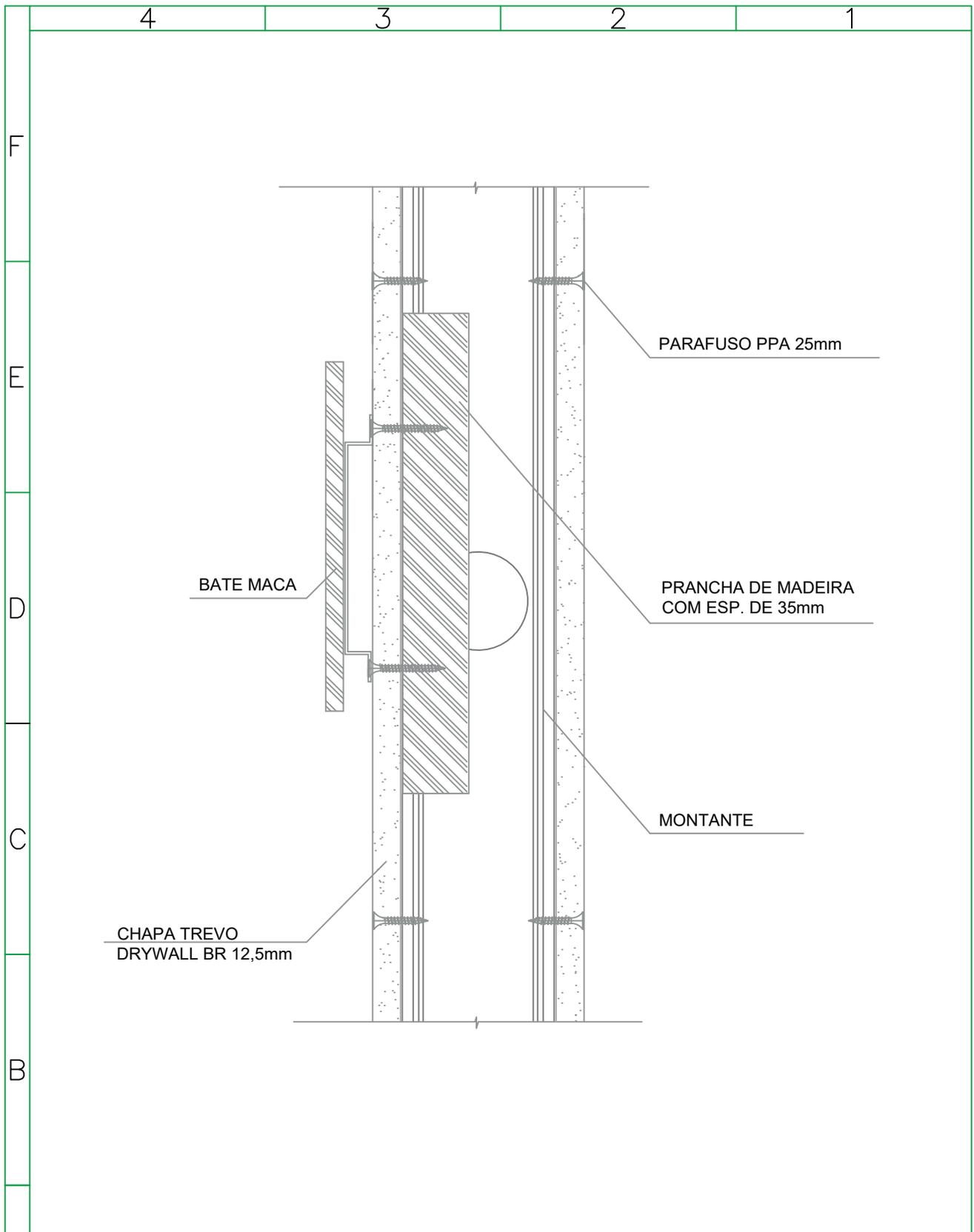
**DETALHE TÉCNICO:** CARGAS E REFORÇOS - FIXAÇÃO DO BATE MACA - CORTE
