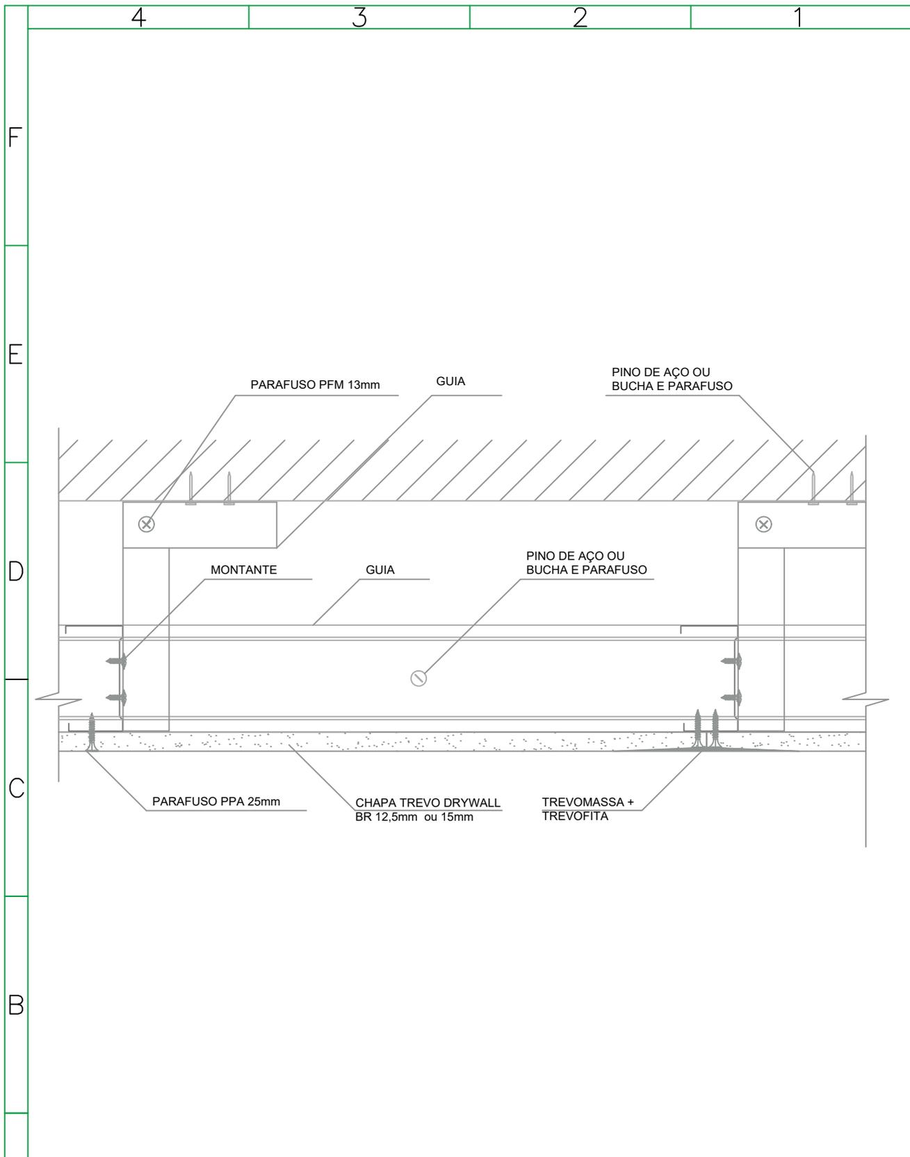
**DETALHE TÉCNICO:** REVESTIMENTO ESTRUTURADO COM TRAVAMENTO INTERMEDIÁRIO - PLANTA BAIXA
