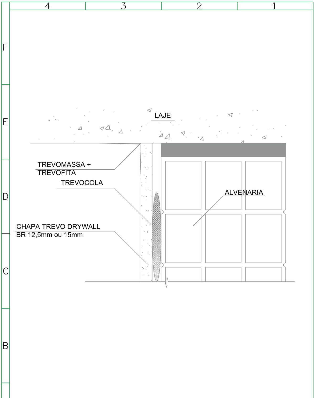
**DETALHE TÉCNICO:** REVESTIMENTO COLADO - CORTE
